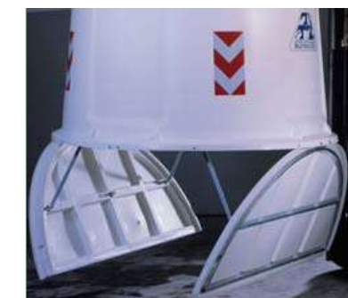
Compuertas de vaciado
